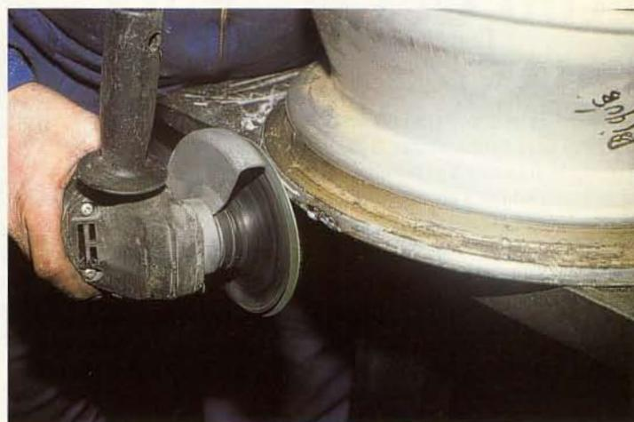
Les pourtours de la jante détériorés par des coups de trottoirs sont repris à chaud avant d'être dégrossis à la meule puis poncés à la main.
