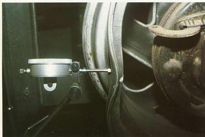
Comparateur et thermomètre électronique permettent à Joël Endewell de travailler avec des tolérances inférieures à celles du constructeur.
