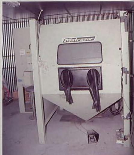
Une des deux sableuses de RC3D. On aperçoit les gants de protection en caoutchouc noir intégrés à la sableuse.
