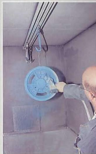
Le champ électrostatique créé entre le pistolet et la cabine permet l'adhérence de la poudre sur la jante.
