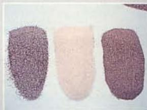
Les trois qualités de grains utilisées par RC3D: de gauche à droite, la grenaille, la microbille, et le corindon.
