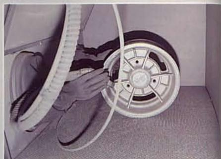
La pièce est placée dans la sableuse. On voit la buse de sablage dans la main droite de l'opérateur.
