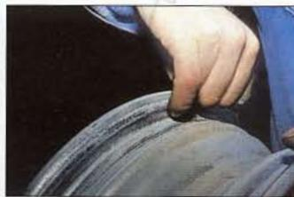
L'état de surface de cette partie du voile doit être parfait de façon à garantir l'étanchéité entre la jante et le pneu tubeless.
