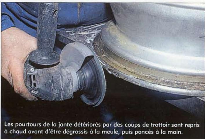
Les pourtours de la jante détériorés par des coups de trottoir sont repris à chaud avant d'être dégrossis à la meule, puis poncés à la main.
