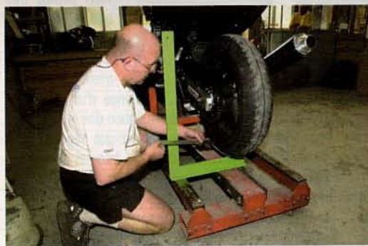
Le parallélisme de l'axe de roue arrière par rapport à l'axe de bras oscillant est contrôlé par une mesure à droite, puis à gauche.
