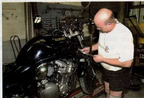
Grâce à une référence de géométrie définie par l'axe de bras oscillant, le professionnel localise la déformation. Ici, on mesure l'alignement de la colonne dans l'axe de la moto.
