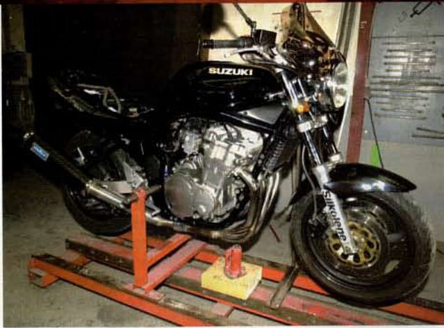
L'axe de bras oscillant bridé sur le marbre donne la référence de perpendicularité nécessaire pour localiser une déformation.
