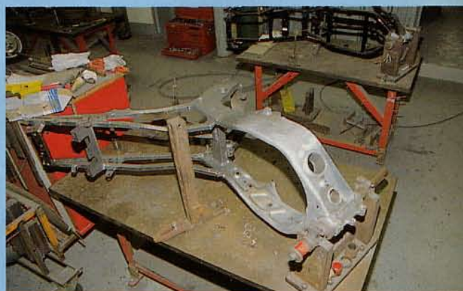
Qu'il soit en aluminium ou en acier, un cadre peut généralement être redressé après un accident. On le fixe pour cela sur un marbre... en acier.
