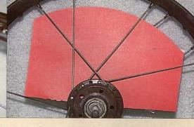
15. Ces rayons extérieurs sont maintenant montés sur la jante. Comme nous avons des rayons un trou sur deux sur le moyeu, ils seront vissés un trou sur quatre sur la jante. Sur la photo, c'est l'occasion de voir que cette roue avant d'Helyett 250 a un croisement de rayons par trois. On répète les opérations des photos 14 et 15 sur l'autre côté de la roue.
