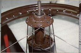
14. La suite consiste à introduire tous les rayons intérieurs d'un même côté dans un trou sur deux du moyeu. On commence par les rayons intérieurs car si l'on débutait par les extérieurs, les intérieurs seraient impossibles à mettre en place.
