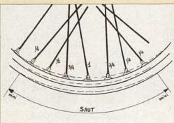
23. Pour régler le saut on applique une pige sur le seat de la jante (là où s'appuie le pneu) et pas sur le rebord ou la gouttière centrale, et l'on fait tourner la roue jusqu'à l'amener dans la position la plus près de la pige : le saut est là ! Pour l'éliminer, on va tendre plusieurs rayons (environ sept) à partir du point central du saut, en tendant de moins en moins du centre vers la périphérie.
