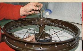
16. Dans les trous restant libres sur le moyeu, on continue en y introduisant les rayons intérieurs d'un même côté puis ceux de l'autre côté. Ils trouvent naturellement leur place sur la jante dans les trous encore libres.
