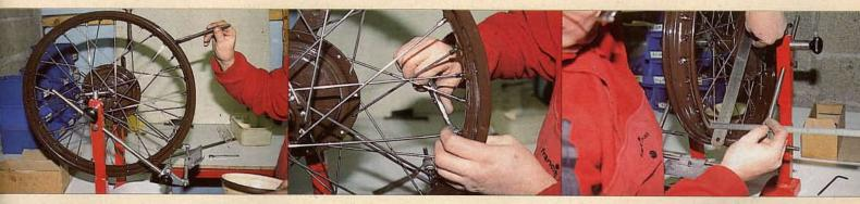
19. Avant de régler la roue, il convient de lubrifier chaque écrou de rayon avec de l'huile de façon à réduire les frictions entre écrous et jante lors de la tension des rayons. La feuille blanche placée sous la dévoileuse permet d'augmenter le contraste et donc de mieux visualiser voile et saut. Ça aussi c'est un truc de pro!
