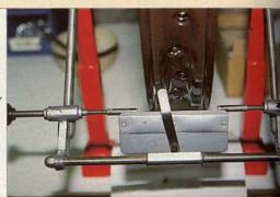
24. Il est fréquent que l'on provoque du voile en réglant le saut et inversement, sans compter que le déport peut lui aussi bouger. Une seule solution : continuer le réglage en agissant à chaque fois par fraction de tour (1/2, 1/4, voir même 1/8\* de tour).
