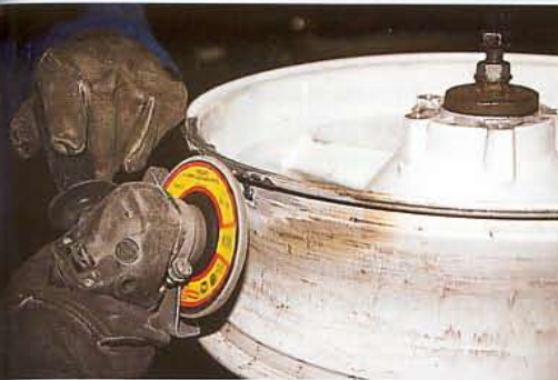
13. Le travail d'usinage commence à la disqueuse en utilisant les différents disques abrasifs présentés à l'étape précédente. Il faut y aller très progressivement et surtout ne pas retirer trop de matière, ce qui obligerait à procéder à un nouvel apport de métal par soudure.
