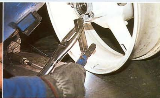
9. Une cassure dans le métal est soudée au Tig sous argon avec une intensité suffisante pour souder à cœur. Ce type de soudure a aussi l'avantage de révéler les prolongements éventuels de la cassure dans le métal, prolongements qui seraient restés invisibles à l'œil nu.
