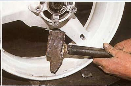
8. Souvent, ce type de fêlure apparaît après une tentative de redressement à froid d'une déformation de la jante. Attention : c'est exactement ce qu'il ne faut pas faire !
