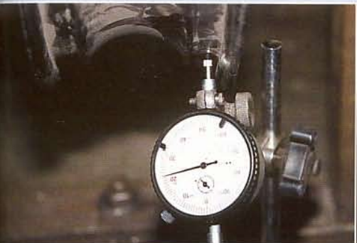
19. La même tolérance de 5/10 e de millimètre est appliquée pour le saut, c'est-à-dire la mesure prise au set de la roue, là où le pneu repose. Là encore, le contrôle révèle une tolérance inférieure puisque le comparateur affiche 21/100 e de saut.
