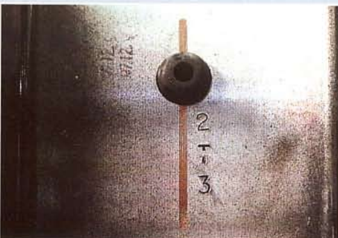
20. Chaque roue une fois terminée reçoit l'estampille RC3D. Les chiffres frappés à froid sur le fond de la jante, à proximité du trou de la valve, indiquent le voile et le saut après réparation ; ici, 2 et 3/10 e . C'est une signature qui est aussi la garantie pour le client d'avoir une roue qui est géométriquement aux normes du constructeur.
