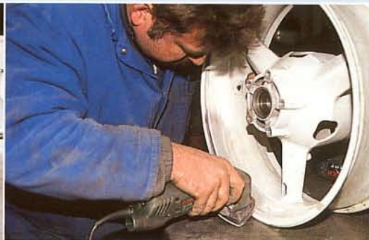
14. L'usinage se poursuit par une première finition à la ponceuse delta en utilisant des émeris de plus en plus fins.
