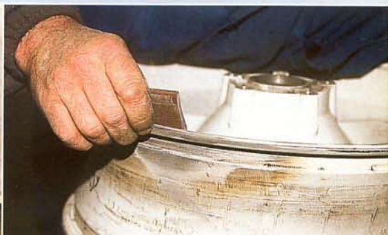
15. Mais la finition finale est réalisée à la main pour respecter au mieux le profil de la roue. Cette étape est importante car elle détermine l'aspect de la roue avant peinture.
