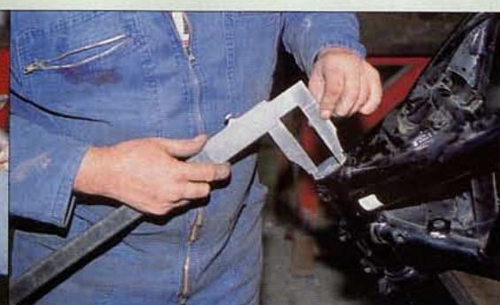
**4.** Il est indispensable d'effectuer une métrologie au niveau du tube de la colonne de direction. En effet, lorsqu'un cadre a subi un choc, il est fréquent que l'alésage du tube soit ovalisé. Conséquence : les cuvettes de roulements de direction ne sont plus concentriques avec tous les problèmes de tenue de route que cela peut engendrer.
