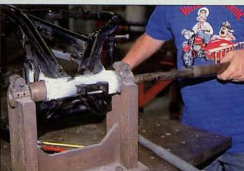
**6.** La suite des travaux se passe sur un marbre, sorte de grande table en acier très épais, parfaitement plane et indéformable, gravée de nombreux repères et percée de trous taraudés à de multiples endroits pour y fixer l'outillage nécessaire au redressage des cadres. La première étape consiste à fixer la colonne de direction sur un support solide du marbre.
