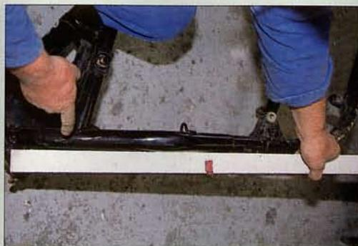
**2.** On peut aussi faire un contrôle sommaire à l'aide d'une longue règle métallique rectifiée. Appliquée le long d'un tube supposé rectiligne, aucun jour ne doit apparaître entre le tube et la règle. Dans notre cas, nous constatons un espace entre la règle et l'un des berceaux, signe que celui-ci est déformé.
