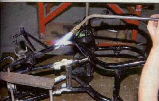
**14.** Tout l'art du spécialiste consiste alors à déterminer les points à chauffer, le temps de chauffe et la température de la flamme. Il n'existe aucune règle académique pour déterminer ces paramètres ; tout est une question de savoir-faire et donc d'expérience.
