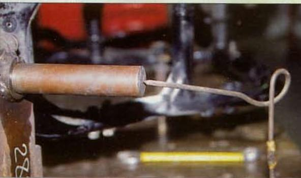
**11.** Toujours dans le cadre des opérations de contrôle, une pointe fixée sur un support, lui-même posé sur le marbre, est ajustée pour pointer sur le centre de la colonne de direction. Cette pointe définit donc une distance par rapport au marbre, distance qui est celle de l'axe longitudinal du cadre.
