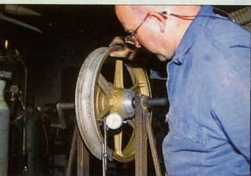
**24.** Avant, pendant et après réparation, la roue est contrôlée au comparateur au niveau de son voile et de son saut. Dans tous les cas, une roue est considérée comme bonne lorsque voile au saut ne dépassent pas 5/10<sup>e</sup> de millimètre.
