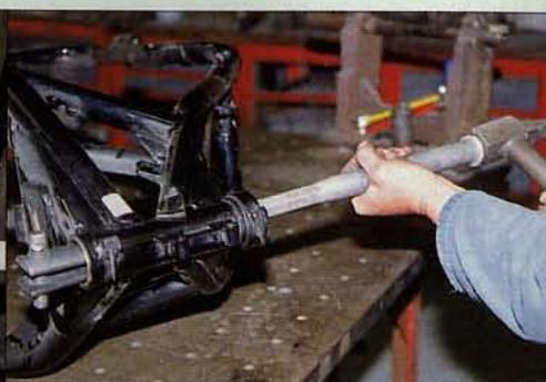
**3.** Avant de commencer les réparations proprement dites, il faut débarrasser le cadre de tous ses accessoires comme le bras oscillant, la plaque du constructeur, les différentes pattes boulonnées et, bien sûr, les cuvettes des roulements de direction.
