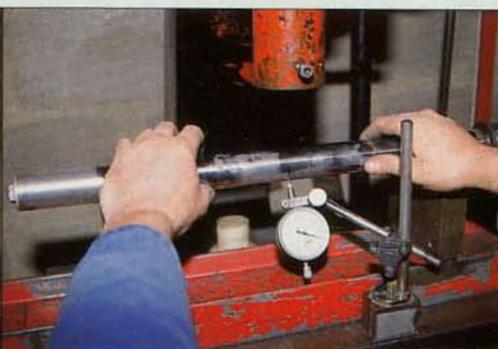
**18.** Il est aussi possible de détordre un tube de fourche dans la mesure où la déformation n'est pas trop prononcée. Pour cela, on détermine au comparateur le faux rond du tube en le plaçant entre deux vés. On peut aussi faire rouler le tube sur un marbre et déterminer son faux rond en glissant une cale d'épaisseur entre tube et marbre.
