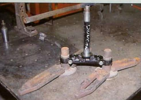
**21.** Pour redresser le té de fourche inférieur, on utilise comme pour le cadre la méthode de la rétreinte à chaud. Ici, le té est emmanché sur deux formes aux dimensions des tubes de fourche puis il est chauffé pour lui redonner sa géométrie originelle.
