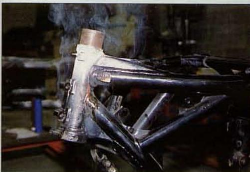
**5.** Pour faire disparaître cette ovalisation, le tube de direction est chauffé au rouge et un mandrin métallique rectifié à la bonne cote est emmanché dans le tube. En se refroidissant, le tube retrouve sa forme adéquate autour du mandrin.
