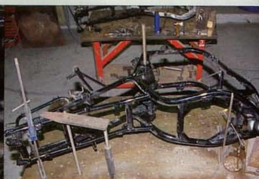
**13.** Différents accessoires sont fixés sur le marbre. Ils servent à brider le cadre pendant la chauffe et sont destinés à "orienter" la déformation des tubes au moment de leur refroidissement.
