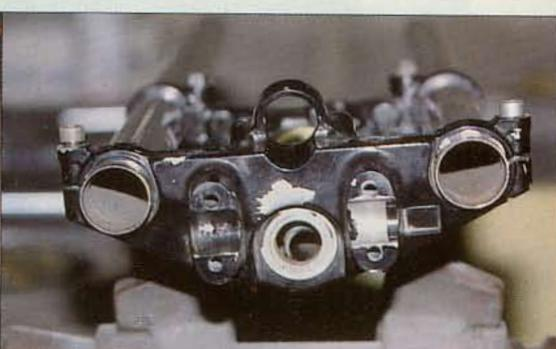
**22.** Une autre méthode de contrôle des tés de fourche consiste à monter nos tubes témoins dans les deux tés. S'ils sont déformés, le pivot de direction ne peut alors entrer dans le trou central du té supérieur.
