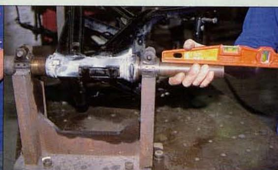
**7.** Une broche rectiligne traverse la colonne de direction et l'on vérifie l'horizontalité de la colonne en appliquant un niveau à bulle sur la broche.
