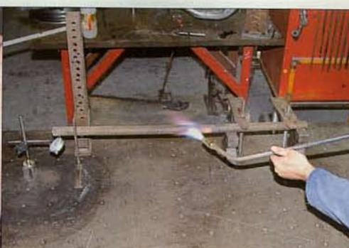
**15.** Pour illustrer le principe de la rétreinte à chaud qui est la base de la réparation des cadres, nous avons réalisé une expérience. Un tube d'acier (tube de chauffage) est immobilisé à l'une de ses extrémités. À l'autre extrémité, nous plaçons une équerre à son contact et un comparateur. Si l'on chauffe le tube en son milieu, sa partie libre va se déformer dans la direction opposée à la flamme puis revenir à sa position initiale, au contact de l'équerre, en se refroidissant.
