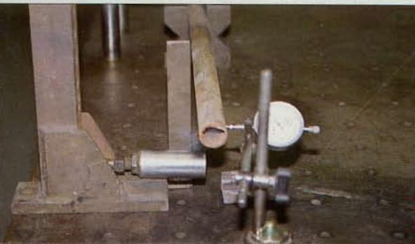
**17.** En revanche, lors de son refroidissement, il va se déformer dans la direction opposée (au point que le vérin qui le cale tombe sur le marbre) et ne retrouvera pas sa place de départ. Cette technique particulière permet de courber un tube sans traumatisme car elle joue sur l'agitation moléculaire au sein du métal.
