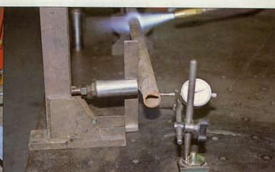
**16.** Ajoutons à notre montage un vérin qui forme butée et va empêcher le tube de se déformer dans la direction opposée à la flamme. Si l'on chauffe le tube à l'identique de la photo précédente, il va chercher à se déformer mais ne le pourra pas, bloqué qu'il est par le vérin.
