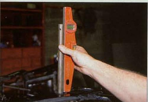
**8.** On introduit une deuxième broche dans les trous de l'axe du bras oscillant ou à tout endroit supposé perpendiculaire à la colonne de direction. Puis, on contrôle la verticalité de cette broche. Si tel n'est pas le cas, le cadre a fortement bougé. Il faut savoir qu'une inclinaison d'un degré correspond sur une portée de 600 mm à une déformation de 10 mm ! Or, le faux alignement maximum toléré entre les roues avant et arrière ne doit pas excéder 3 mm !
