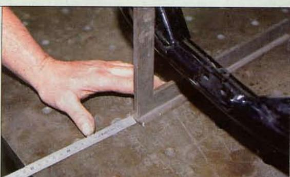
**10.** Ces cotes relevées par le professionnel sont toujours par rapport à un marbre qu'il possède. Dans le cas présent, on voit la mesure de la distance entre un berceau et un point défini et gravé sur le marbre. Dans ses notes relatives à ce modèle de cadre, le pro aura par exemple noté : « Distance entre le berceau droit et le point 73 du marbre : 41 mm. » Plusieurs mesures sont ainsi prises qui donnent une idée précise de la déformation du cadre et donc du traitement à lui faire subir.
