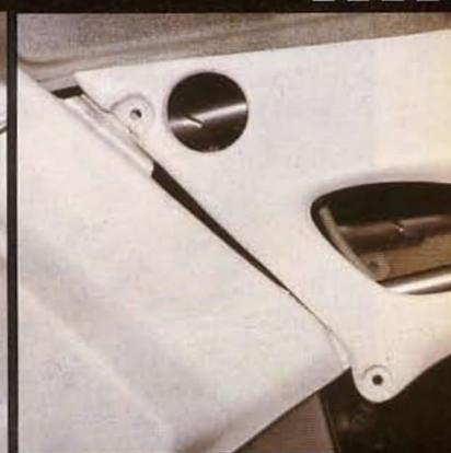
Avant le vissage des polys, on aura au préalable percé en douceur les attaches de fixation. On utilise un petit foret en métal pour passer progressivement à la taille ad hoc.
